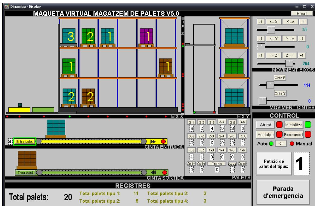
La prestatgeria té una capacitat reduïda pel fet de que és una simple simulació sense basar-se en cap cas real. En el cas real de voler realitzar un control d'una prestatgeria amb capacitat per a 18 palets, molt possiblement, no sortiria gens rentable invertir-hi per a automatitzar-ho. Així doncs, s'ha creut convenient que amb 18 palets n'hi ha més que suficient per a fer-se la idea per al control d'un magatzem automàtic.
