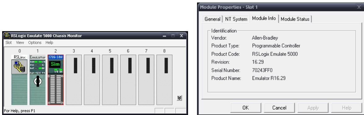
La eina de l'emulador és molt útil davant la impossibilitat de disposar d'un automatisme, per a realitzar proves de control sense la necessitat de tenir un autòmat.
