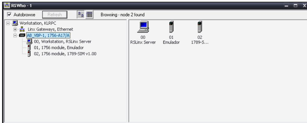
Per a la connexió del RSView (SCADA) i el PLC, s'utilitza la tecnologia OPC. El OPC (OLE for Process Control) és un estàndard de comunicació molt utilitzat per al control i supervisió de processos. Aquest protocol permet que diferents fonts (servidors OPC) envii dades a un mateix client OPC, que a la vegada podran connectar-se diferents programes compatibles amb aquest estàndard.
