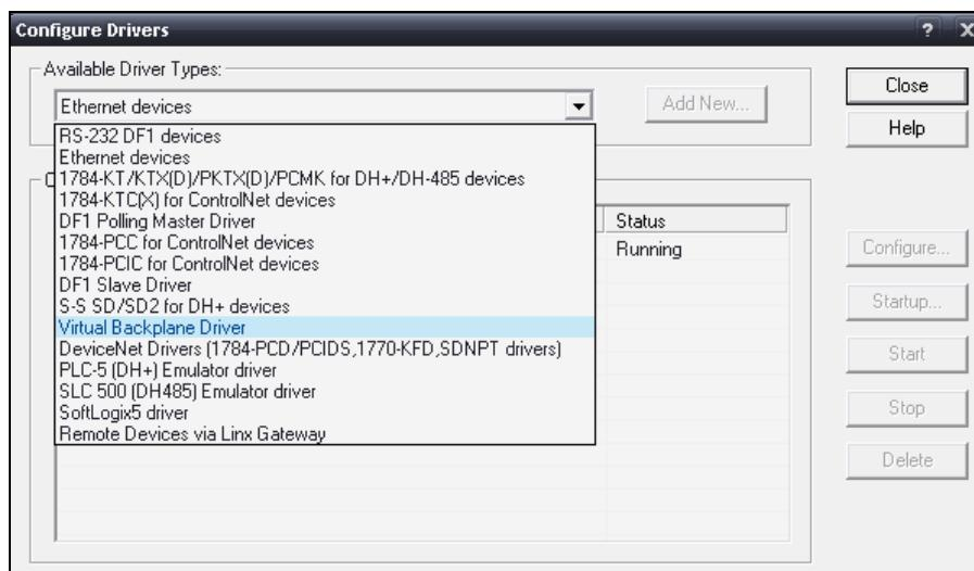
Un controlador és la interfície de programari al dispositiu de maquinari (exceptuant el cas que s'utilitza per a la realització del projecte) i permet la connexió amb el RSLinx.
