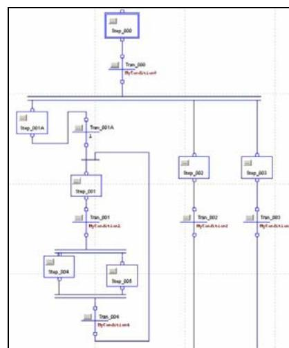
Programació en esquema o CFC: És un tipus de programació en el que el programador pot interconnectar els diferents blocs que necessiti, representant aquests blocs, operacions, comparacions, instruccions predefinides o altres blocs de funcions prèviament programades.
