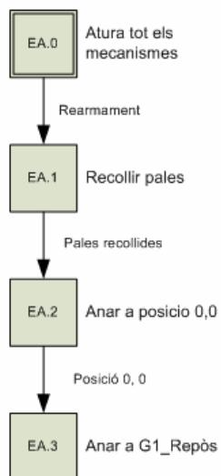
En aquesta rutina només s'activa en quant és produex alguna alarma o una parada d'emergència. El que realitzarà la rutina és la parada immediata de tots els mecanismes del sistema per evitar la col·lisió o, en pitjor cas, per no agreujar l'accident.
