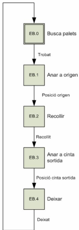
La rutina de buidatge pot ser molt útil per al cas en que sigui necessari realitzar un manteniment a la instal·lació i per tal de buidar el magatzem, el sistema ho faci automàticament i en comptes de realitzar peticions de sortides de palets.
