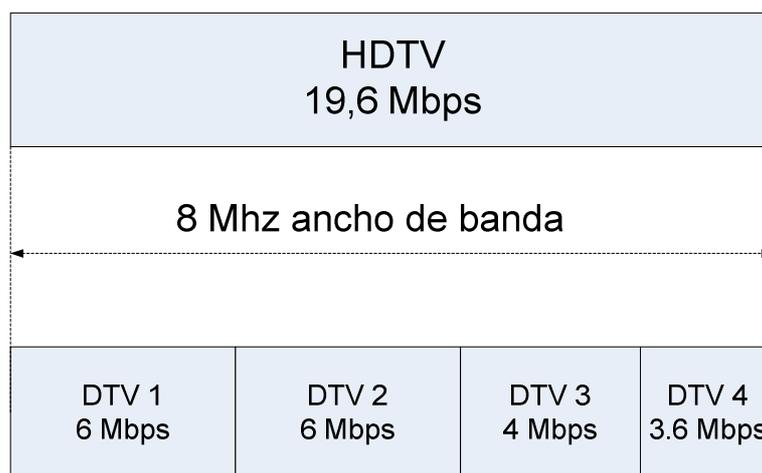
Fig. 2.9 Esquema modulación no-jerárquica
