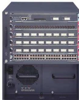
Fig. 9.1. Chasis modelo WS-C6509-E.
