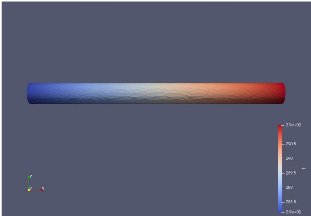
Fig. 7.45 Resultado térmico de la tubería [K] a 1 segundo.
