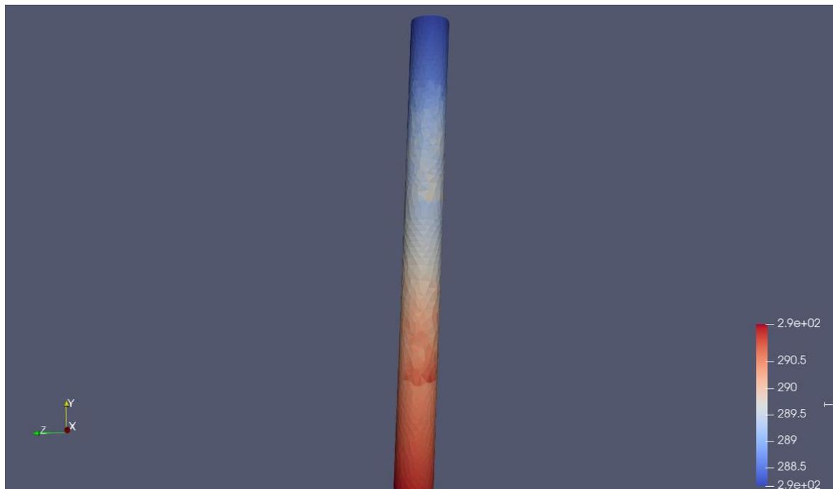
Fig. 7.108 Resultado térmico de la tubería [K] a 1 segundo.
