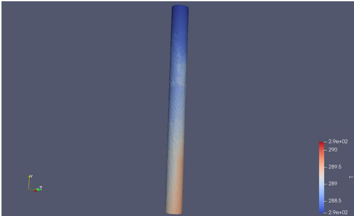
Fig. 7.115 Resultado térmico de la tubería [K] a 8 segundos.
