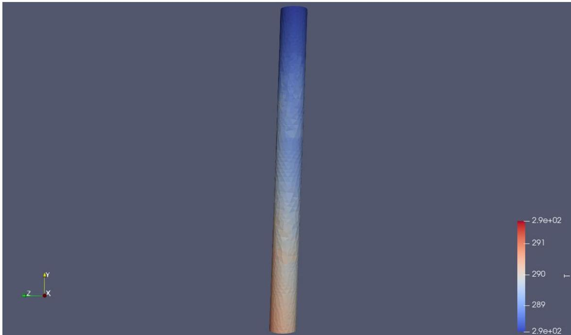
Fig. 7.103 Resultado térmico de la tubería [K] a 8 segundos.
