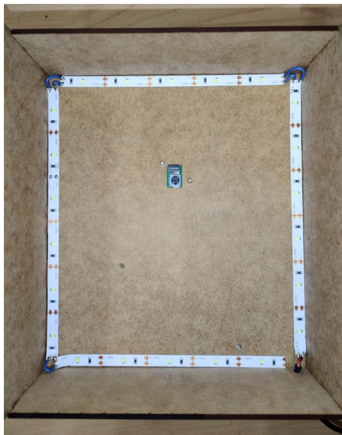
Figura 5.7: Càmera i LEDs del sistema d'il·luminació. Font: Elaboració pròpia.
