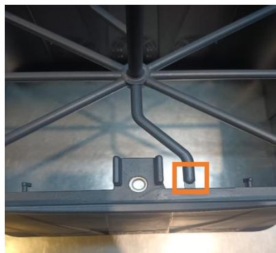
Figura 3-11: Arqueta amb canals resultants del procés d'injecció; Font: [9]
