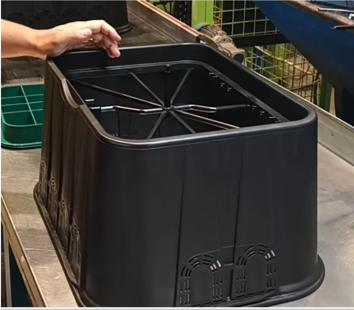
Figura 3-10: Arqueta amb canals resultants del procés d'injecció; Font: [9]
