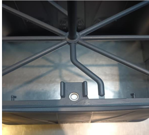
Figura 3-7: Vista dels runners de l'arqueta; Font: [9]
