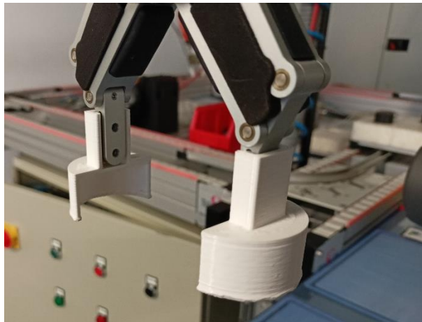
Figura 4.10 Nous grips instal·lats en el RG2 [Font pròpia]
