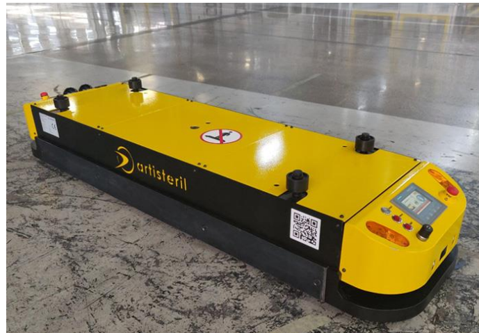
Fig 2.1 AGV Mouse RT1500, utilizados en la fábrica de automoción Seat Martorell. Fuente propia.
