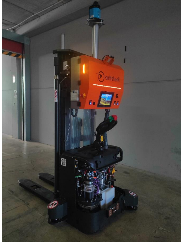
Fig 6.23 AGV de tipo apilador. Usado para las pruebas con el modelo RL. Fuente propia.
