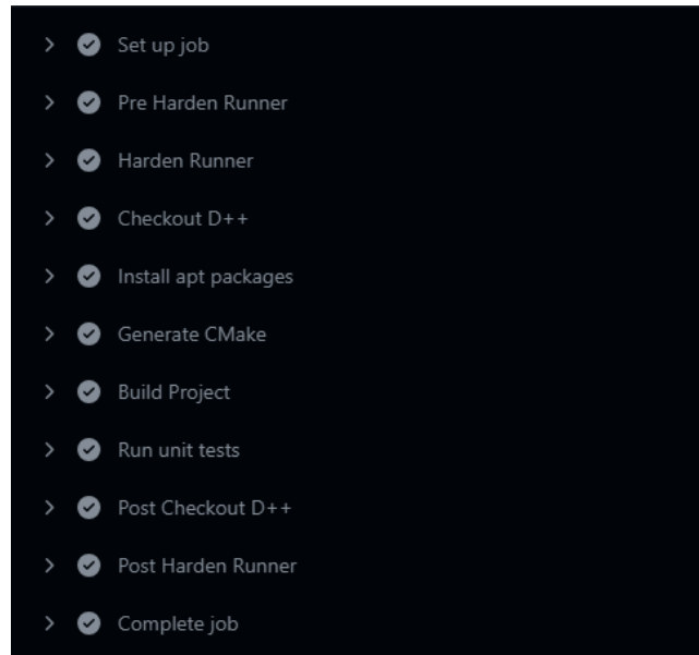
Imatge 4: Fases internes d'un test per a Linux AMD de la llibreria DPP
