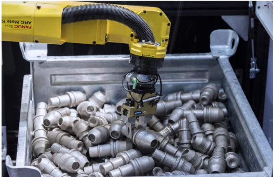
Figura 6.36 Exemple d'emmagatzematge de les peces amb una caixa que incorpora visió per ordinador que permet orientar i treballar amb les peces. [8]
