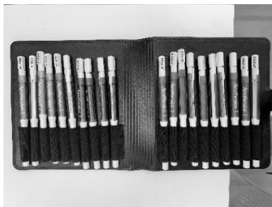
Figura 6: Filaments de Von Frey que s'aplicaran per a la presa de dades durant les intervencions. Son un total de 20 filaments i oscil·len entre 0,008grams i 300 grams.
