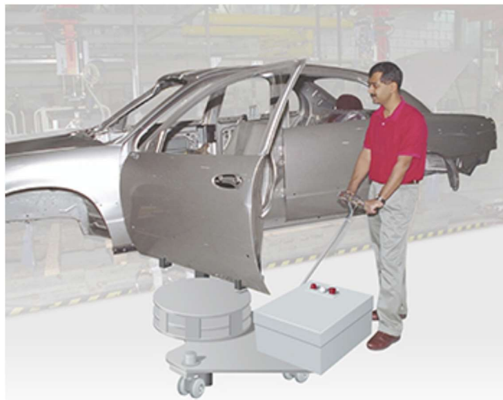
Fig. 3.2 Cobot treballant en una assembladora de cotxes en la fabrica GM
