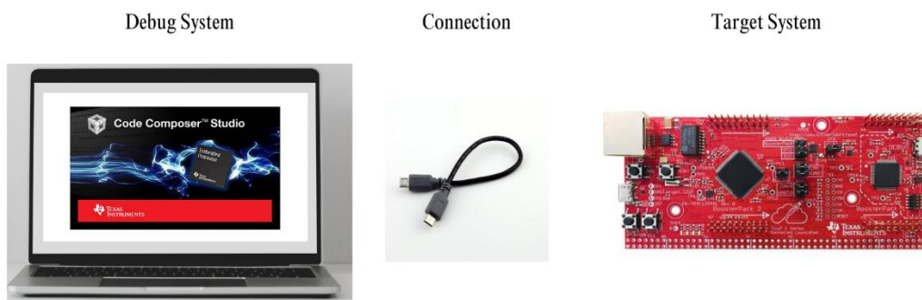
Fig 13. Conexión/configuración hardware de los componentes. [Fuente: EP]
