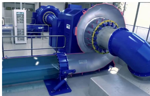
Fig. 2.5 Tall de secció de la càmera espiral, turbina Francis [6]
