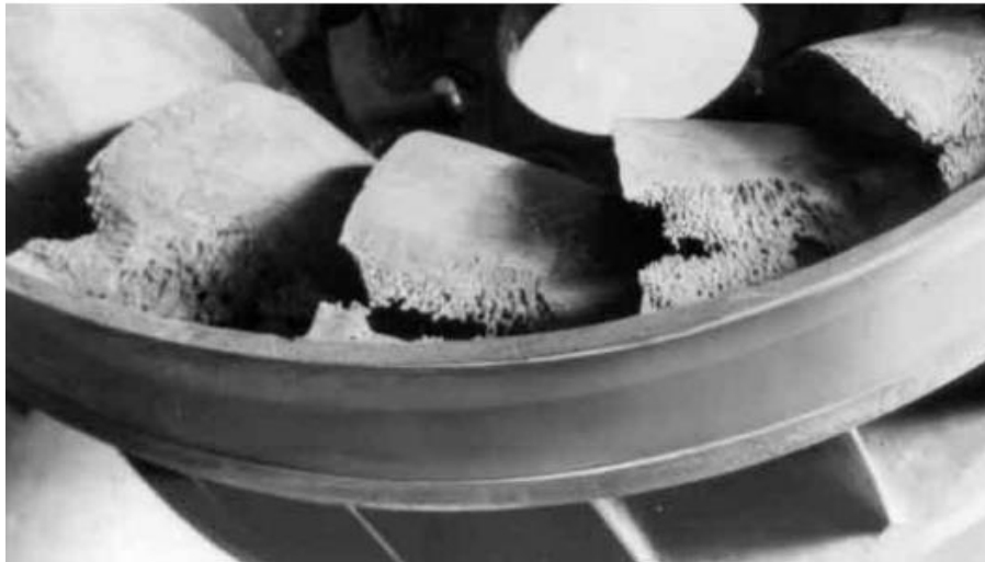
Fig. 2.18 Destrucció per cavitació, conegut com a pitting [7]
