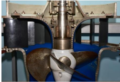
Fig. 2.10 Vista interna turbina Kaplan [5]
