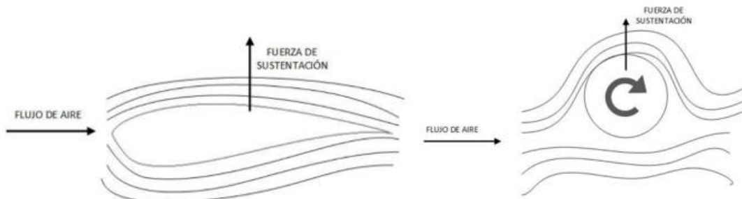
Fig. 3.4: Perfil asimètric i efecte Magnus [14]
