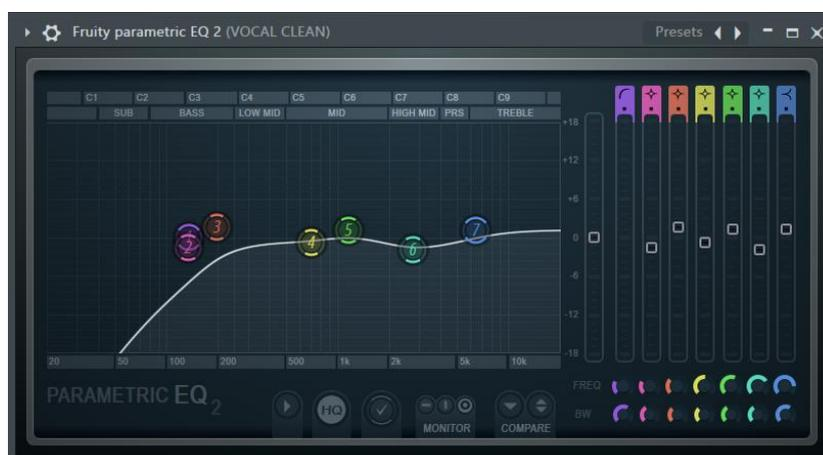
Fig. 5.3.3. Ecualizador paramétrico en la cadena de efectos para limpiar voces.
