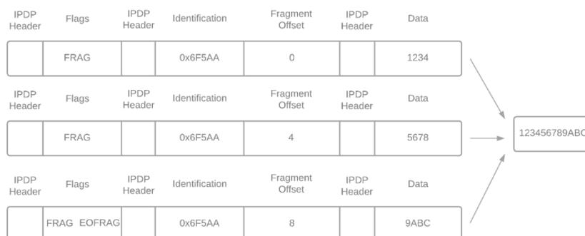
Figura 21 Reconstrucción de un paquete fraccionado. Fuente: propia.
