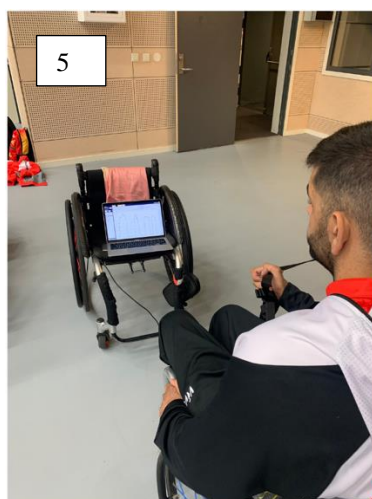
Ilustración 5. Colocación del dispositivo portátil a la vista del jugador para recibir feedback de la fuerza máxima realizada Nota. Elaboración propia 3
