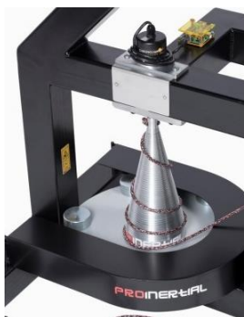
Figura 12. Polea cónica Pulley PRO C3 con el Encoder rotatorio de Chronojump.
