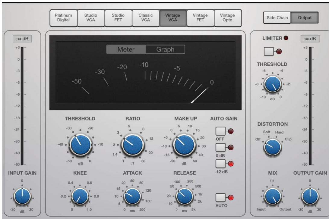
Figura 6. Compressor Vintage VCA aplicat al Baix
