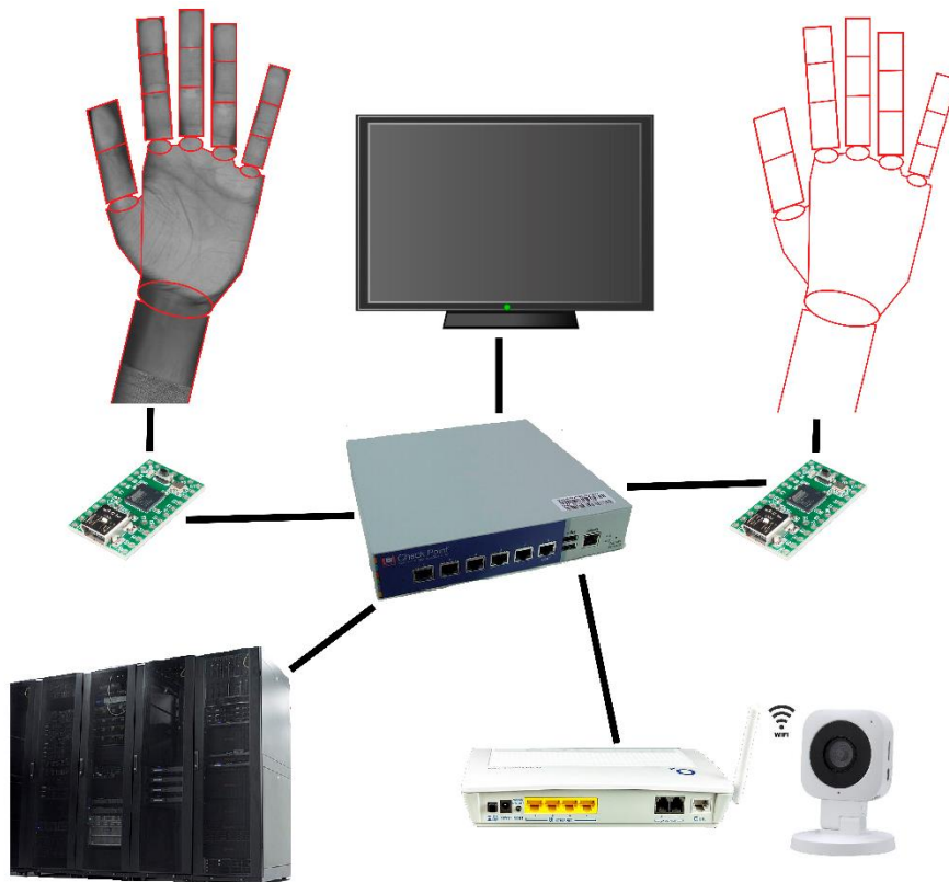
Fig. 2.1. Xarxa LAN d'un manipulador teleoperat [1] [2]
