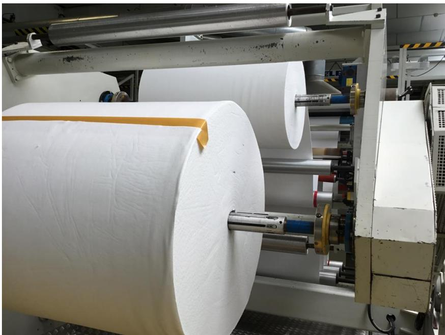
Figura 4.4: Visión sistema revólver.
