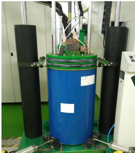
Figura 4.5: Bidón de adhesivo colocado en el fusor.
