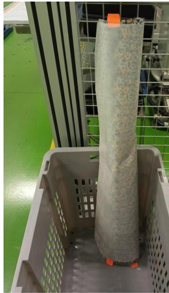
Figura 8.1: Rollo de sección defectuosa de soporte
