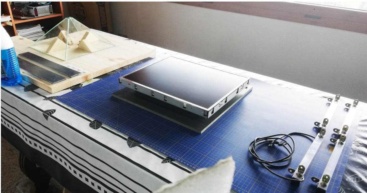
Fig. 4.2. Anclaje de la pantalla a la base superior del dispositivo.
