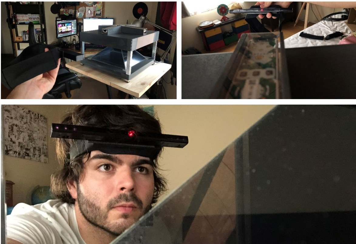
Fig. 6.6. Fotografías del sistema de headtracking implementado con Wii Remotes .
