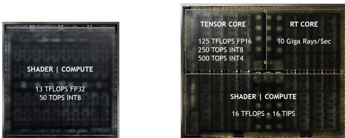
Figura 4. Arquitectura de Nvidia Pascal vs Turing
