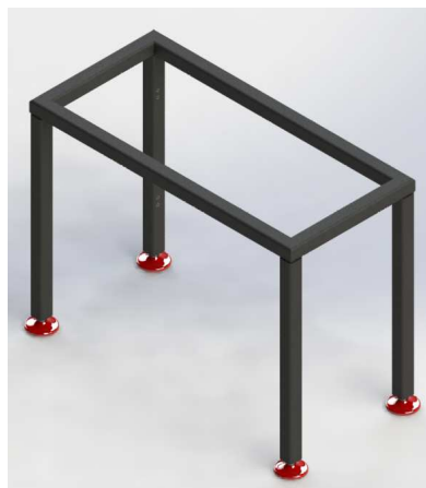
Fig. 7.5. Imatge de la bancada del sistema execució. (Font pròpia)
