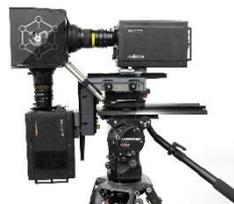
*Ilustración 3: Beam Splitter lateral*
