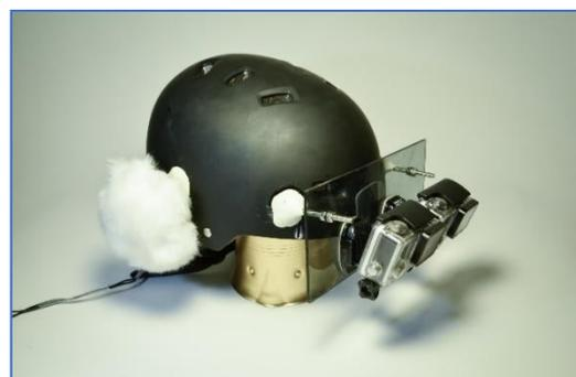
Ilustración 41: Casco con protectores de viento
