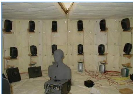
*Ilustración 16: Medición de HTRF y HRIR*
