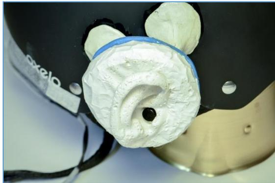
*Ilustración 38: Micrófono colocado dentro del molde de silicona.*
