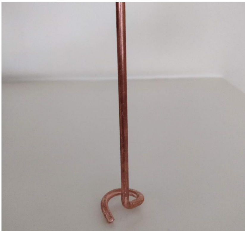
Figura XXXV Bobina de mitja volta [Elaboració pròpia]
