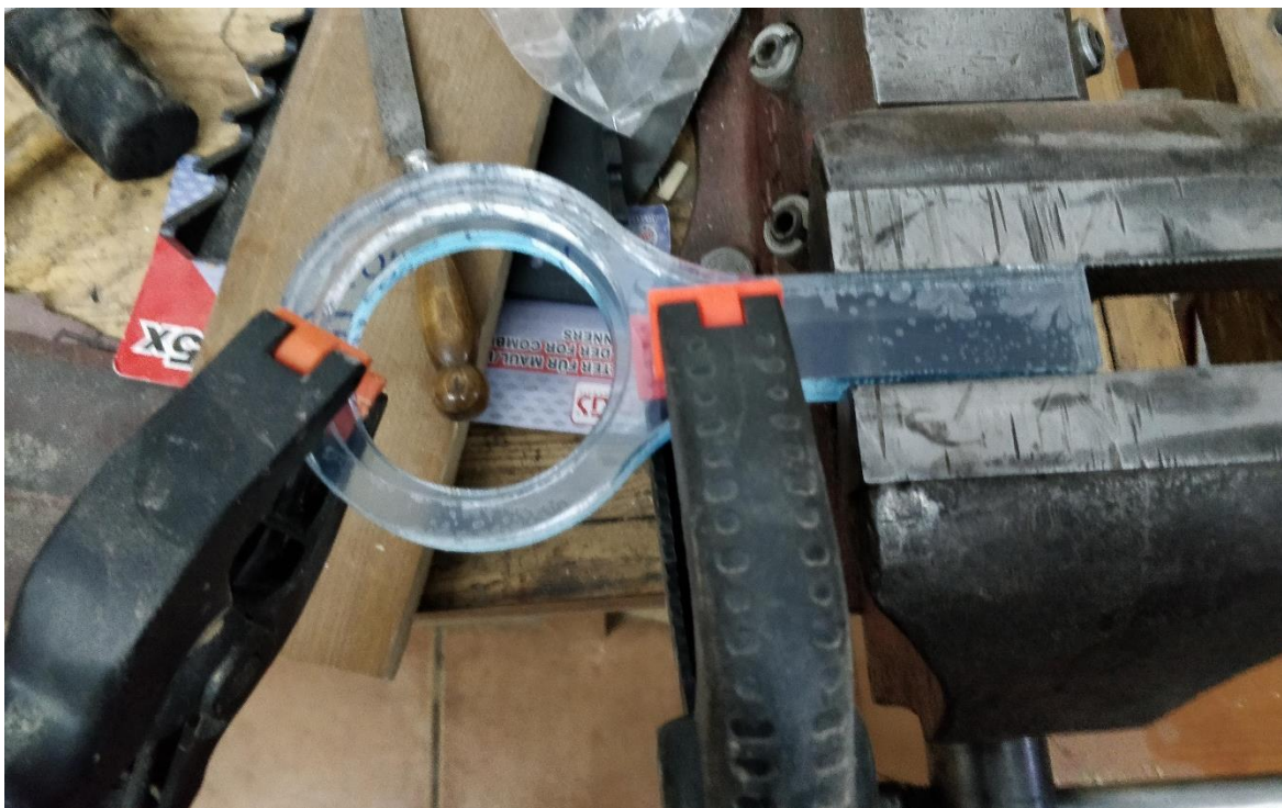
Figura XXIX Unió de les diferents parts del suport de la cassoleta vista 2 [Elaboració pròpia]
