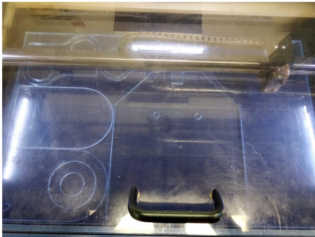
Figura XXI Tall de les peces de metacrilat amb làser [Elaboració pròpia]
