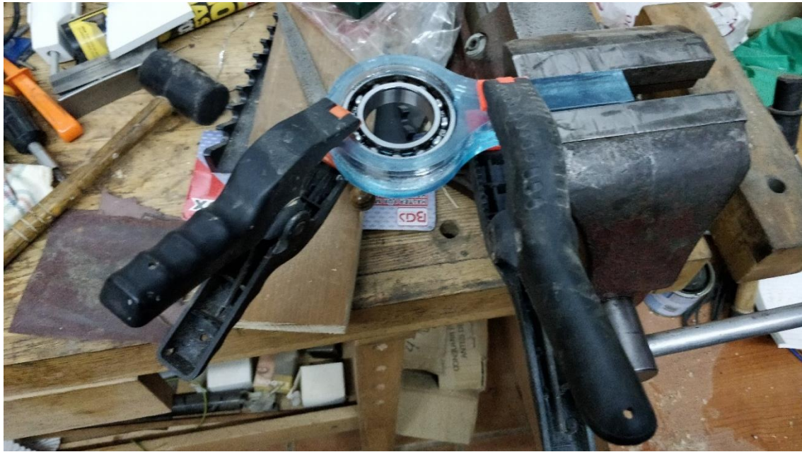
Figura XXXI Comprovació del ajustament del rodament dins del suport de la cassoleta [Elaboració pròpia]
