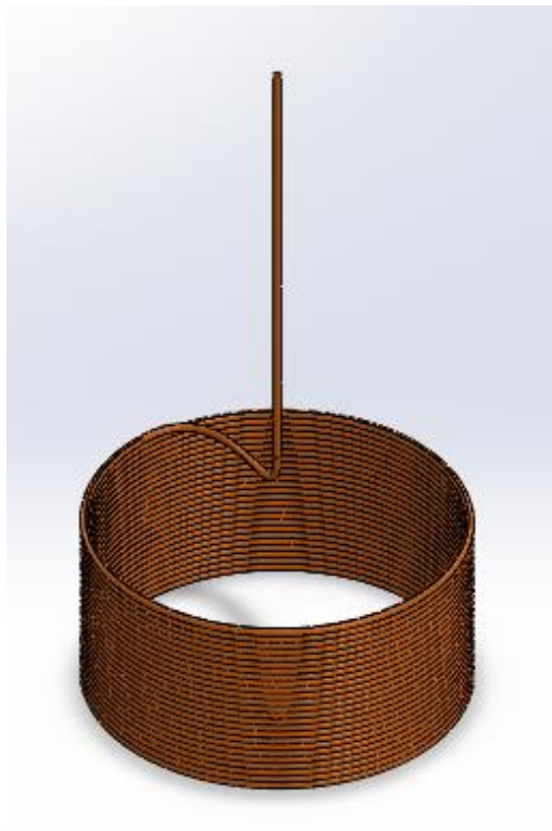
Figura 7.9 Bobina de 99 mm de diàmetre [Elaboració pròpia]
