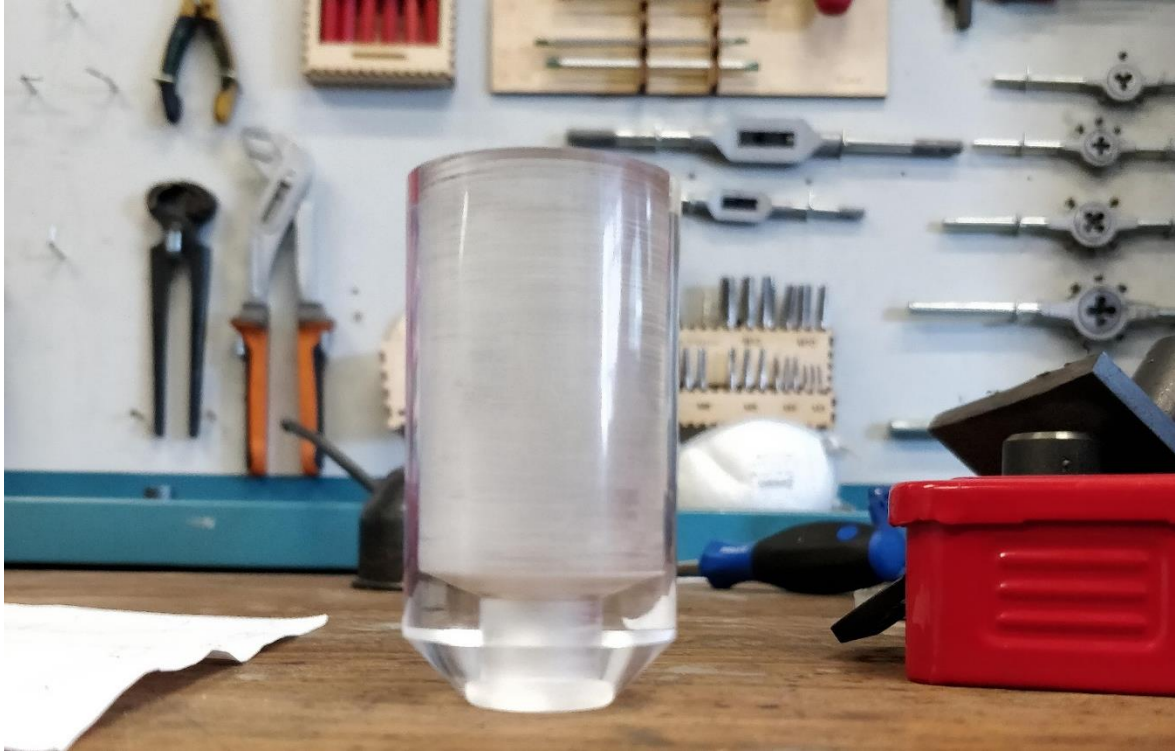
Figura XXVII Resultat de la cassoleta de metacrilat despès de mecanitzar-la amb el torn vista 2 [Elaboració pròpia]
