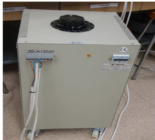
Figura 3.14 Autotransformador con ruedas
