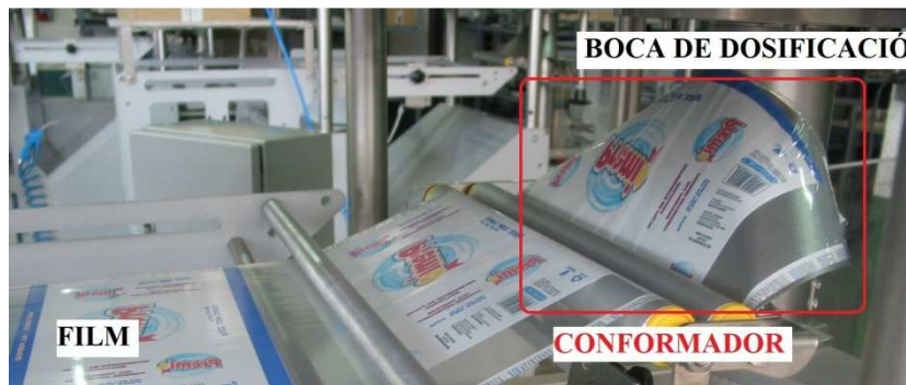
Figura 3.9 Detall de la formació del film
