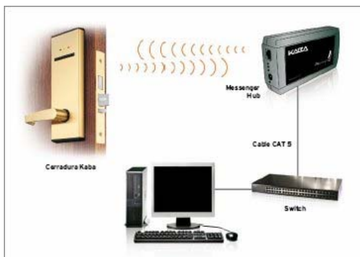
Figura 17: Sistema de pany electrònic proposat
