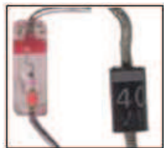
Figura 3.6. A l'esquerra un díode tipus bigoti de gat, a la dreta un díode rectificador convencional.
