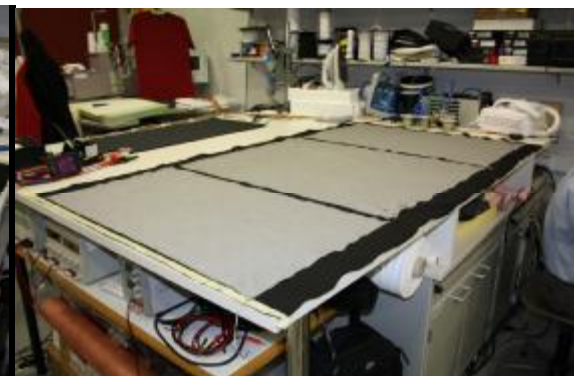
Figura 3.10. Los 3 pads cosidos a base textil.
