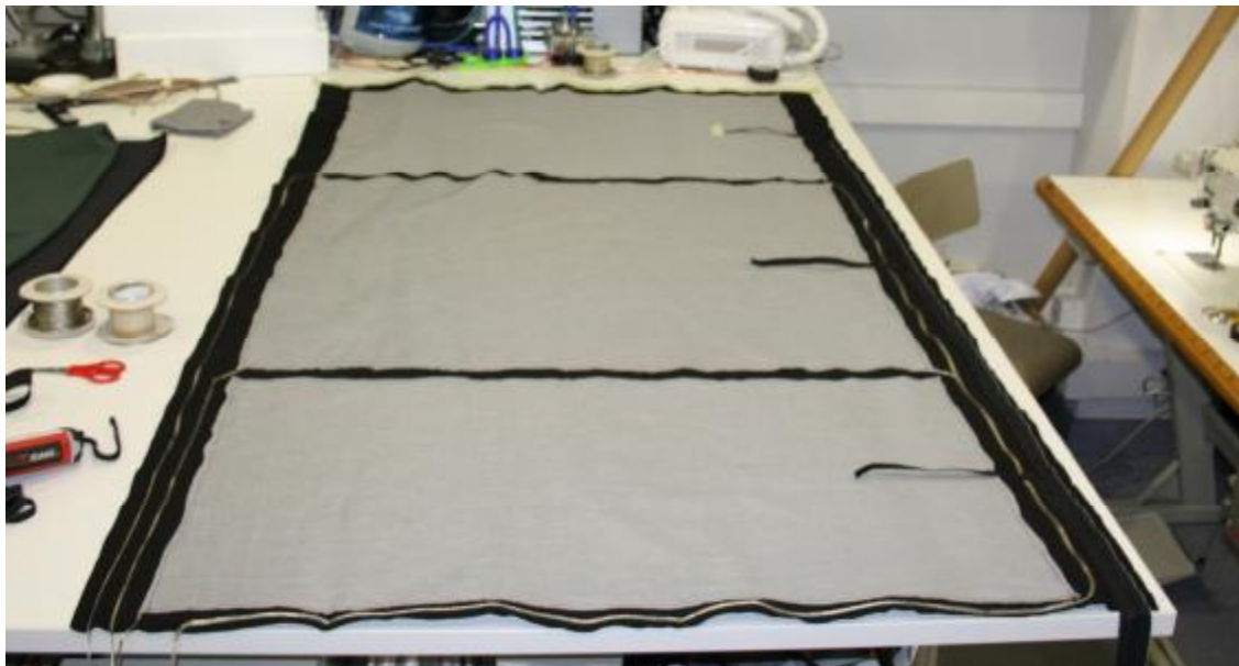
Figura 3.17 Conjunto textil a falta de los sensores de temperatura.
