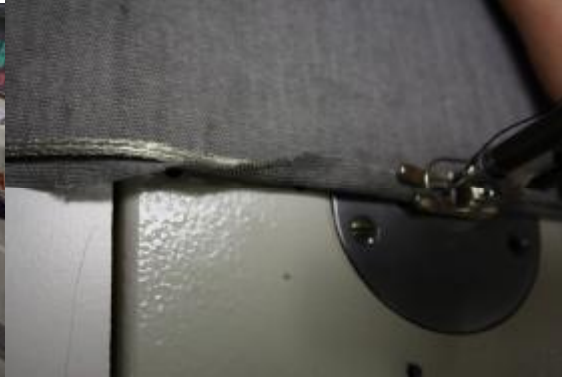
Figura 3.8. Doblegue en el cosido.
