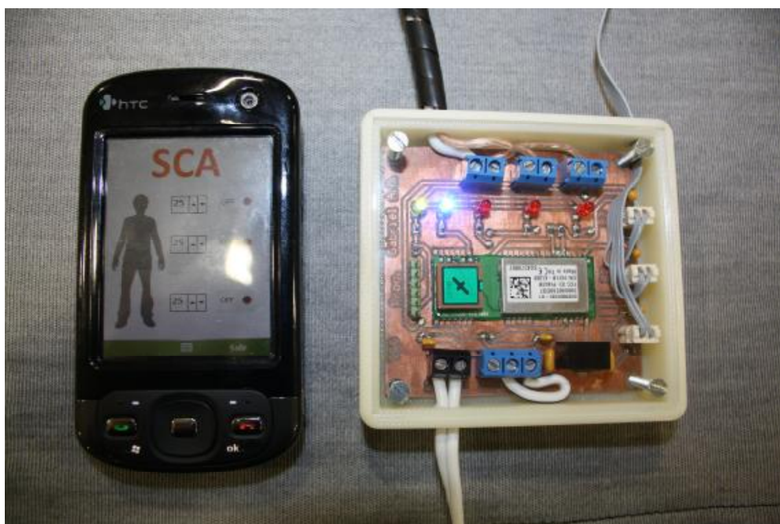
Figura 5.5. Paso 2: Conectar PDA con PCB. LED azul encendido.
