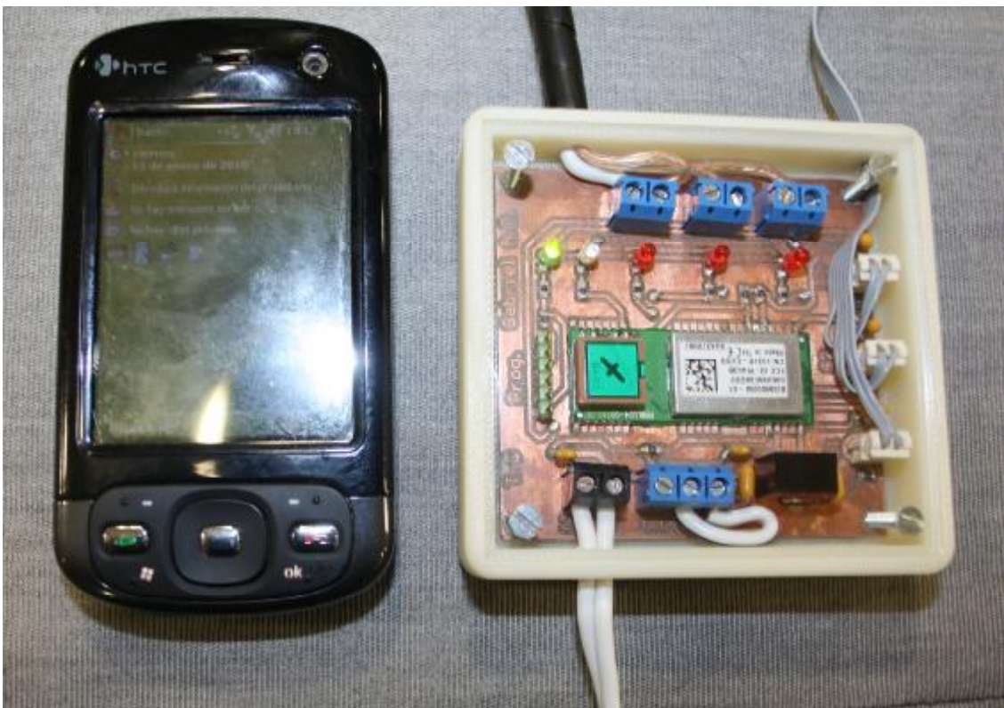
Figura5.9.Paso 6:Salir de la aplicación. Apaga todos los LEDs excepto de alimentación
