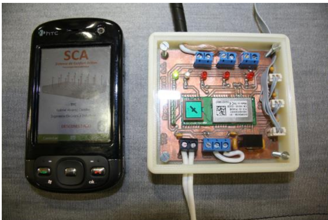
Figura 5.4. Paso 1: Alimentar PCB y entrar en software de PDA. LED verde encendido.
