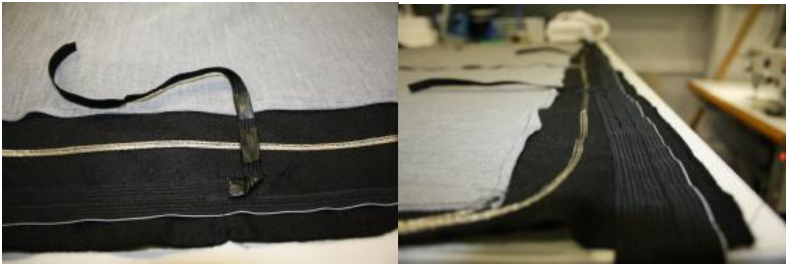
Figura 3.15. Cableado textil para sensores. Figura 3.16. Bus textil de los sensores NTC.
