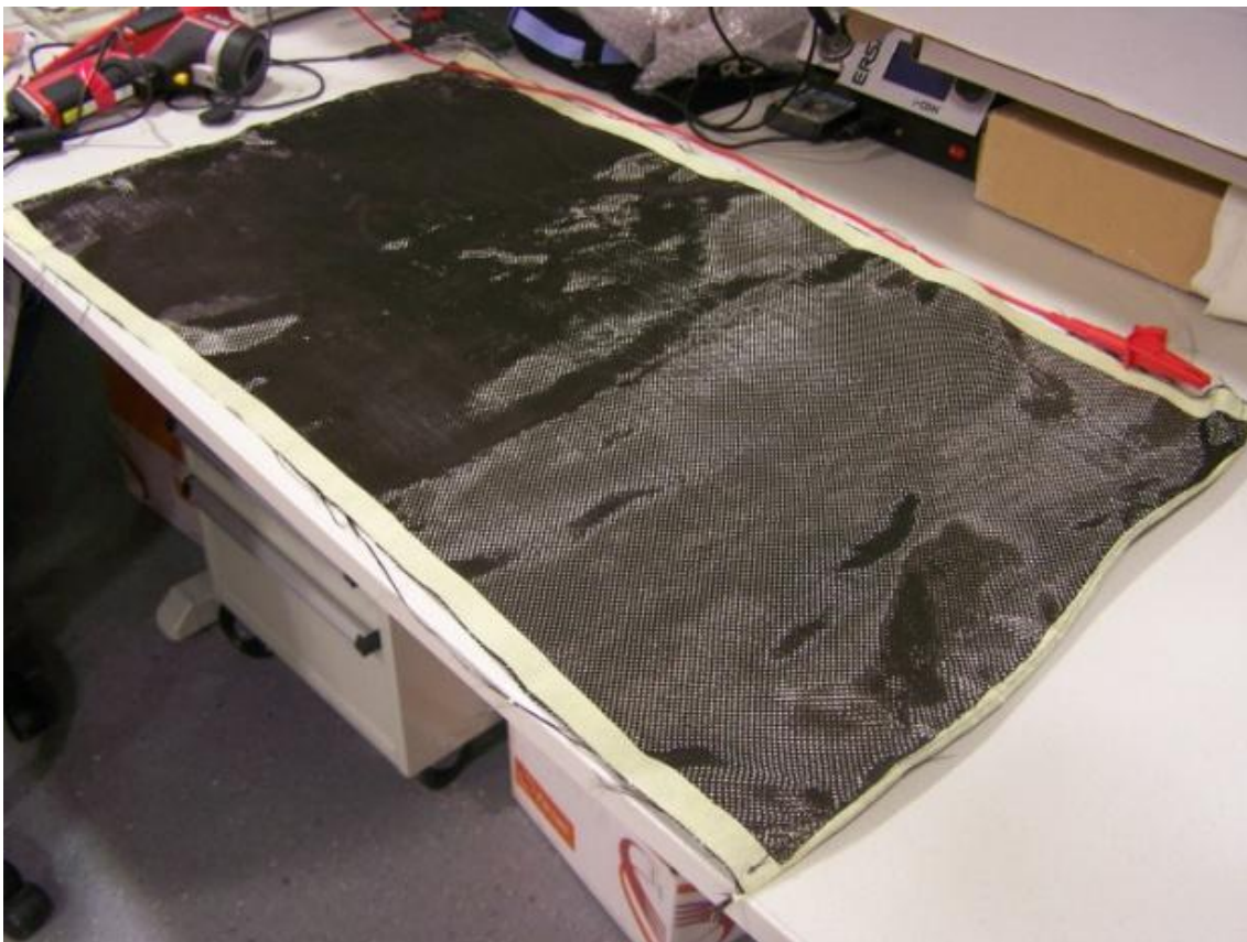
Figura 2.4. Tejido de calada con hilos de Fibra de carbono.
