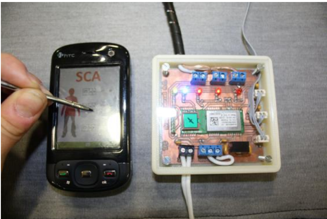
Figura5.7.Paso 4: Encender Pad 2(Tronco).LED rojo2 encendido, si Consigna > NTC2.
