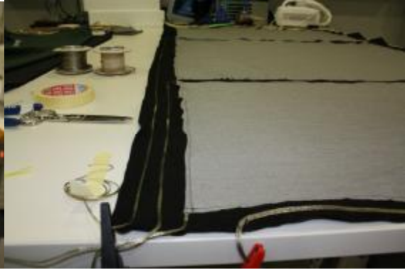
Figura 3.12. Cables independientes por pad.
