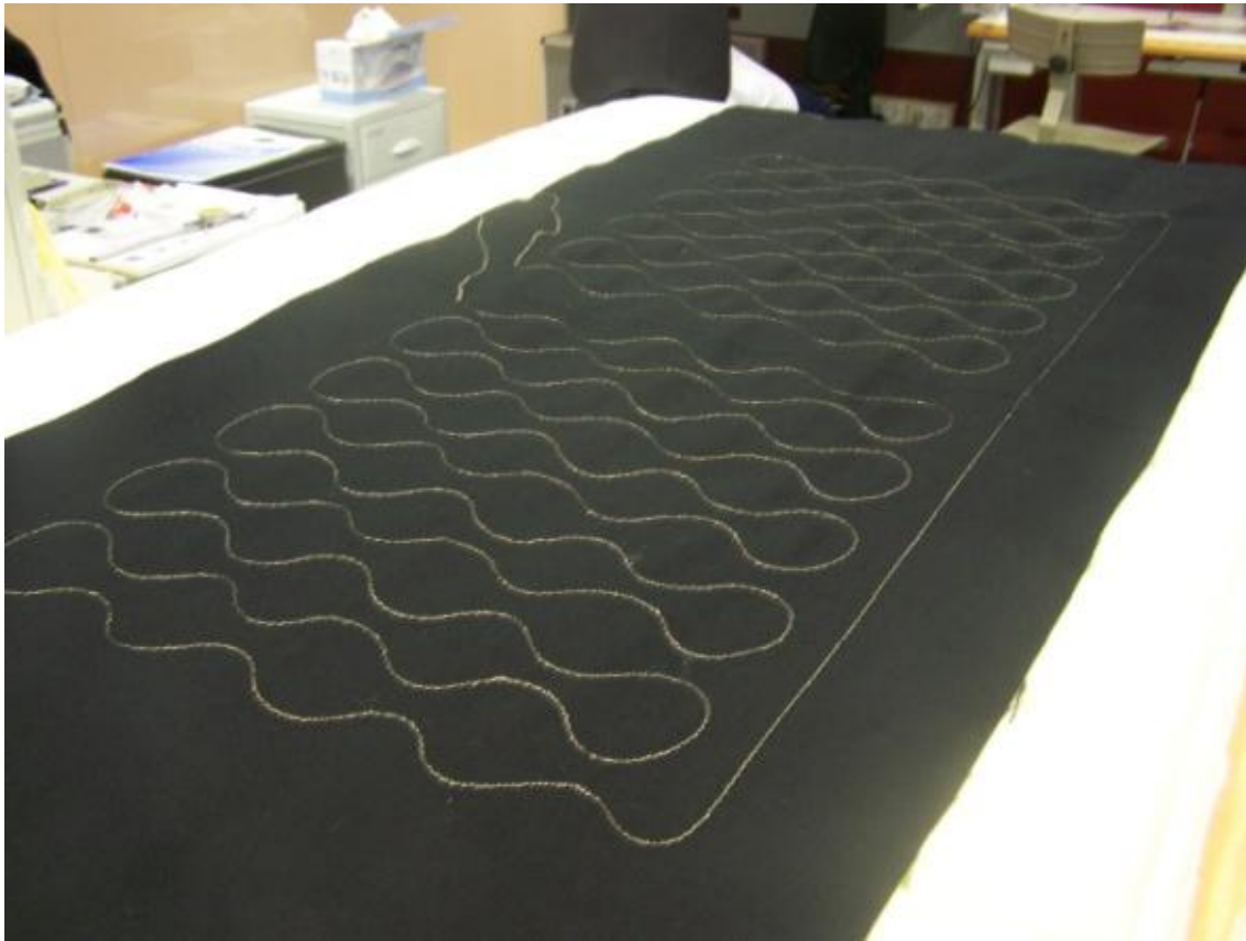
Figura 2.13. Tejido Hilo de cobre/aramida bordado.
