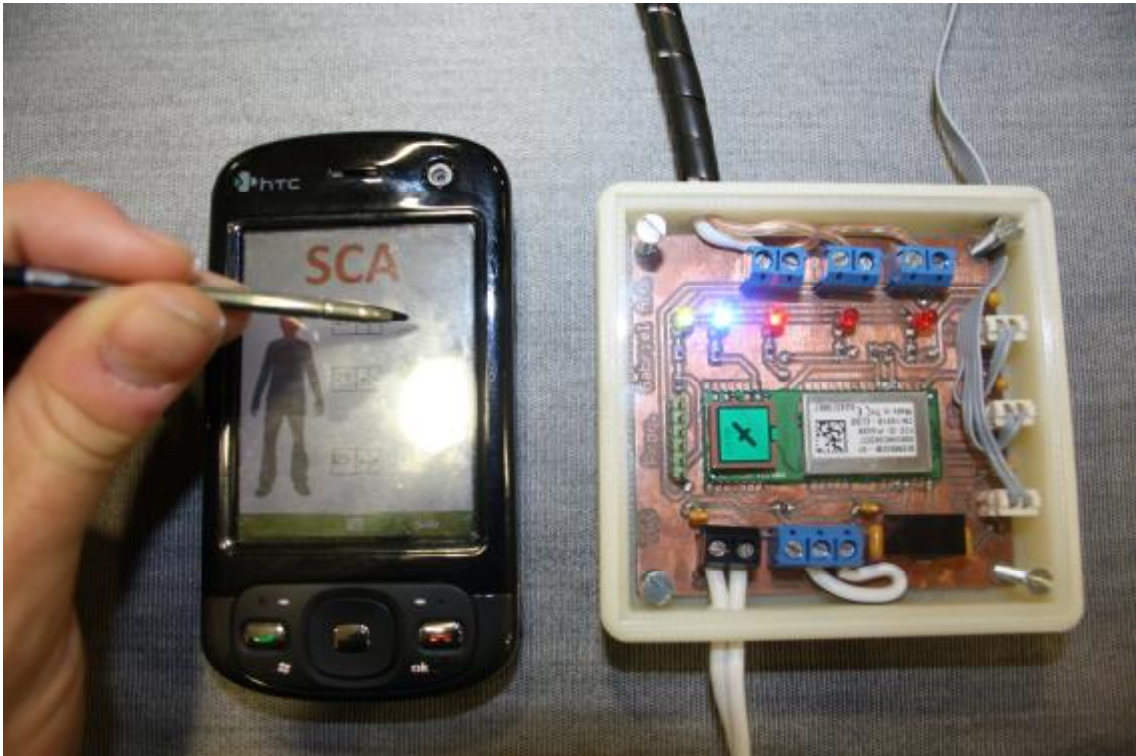
Figura5.6.Paso 3: Encender Pad 1(Cabeza).LED rojo1 encendido, si Consigna > NTC1
