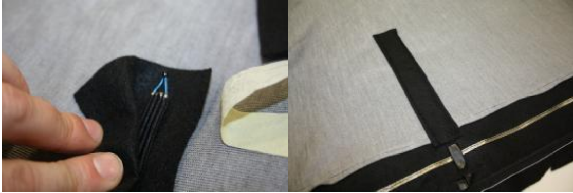
Figura 3.18. Sensor conectado a cable textil. Figura 3.19. Acabado sensores temperatura.
