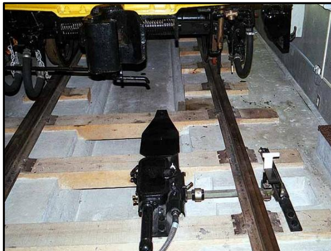
Figura 2.2.11.1 - Caixes receptores ATS instal·lades a les vies (Font: Google Images - images.google.es)
