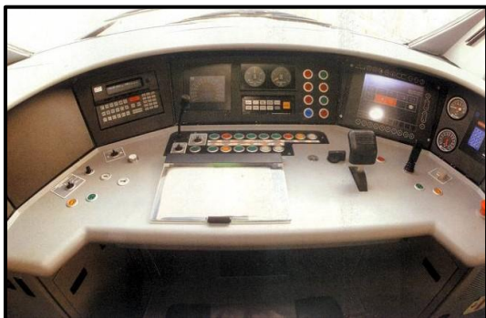
Figura 3.2.3.6 - Panell de control de cabina ASFA (Font: RENFE)
