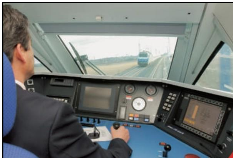
Figura 3.2.2.18 - Taulell de control de cabina del Siemens S-103 (Font: RENFE)
