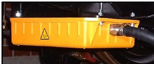
Figura 3.2.2.10 - Antena ERTMS sota els combois (Font: Google Images - images.google.es)
