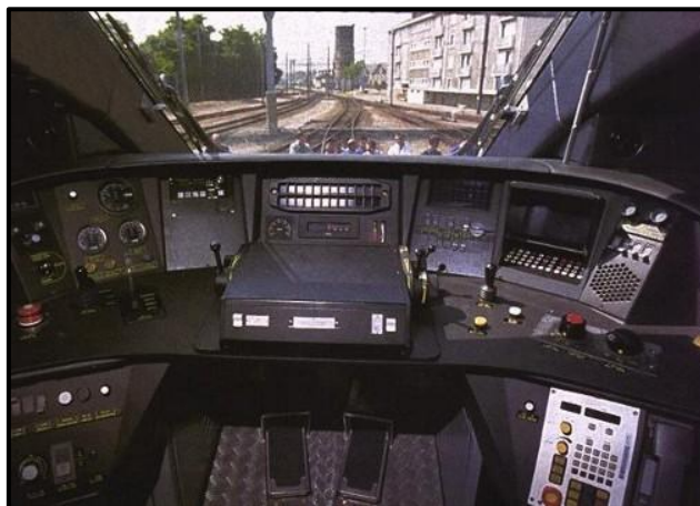
Figura 2.2.7.1 - Panell de control de cabina TVM
