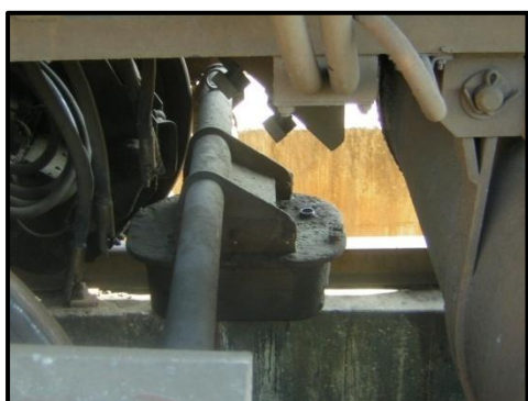
Figura 3.2.3.5 - Receptor de senyal ASFA sota el tren (Font: Ferropedia - Article "ASFA")
