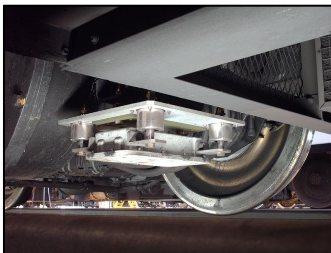
Figura 2.2.8.1 - Antena receptora ATP sota els combois (Font: Web no oficial del tramvia de Catalunya - www.tramvia.org )
