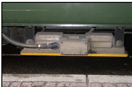
Figura 2.2.6.2 - Imant ressonant PZB sota els combois (Font: Ferropedia - Article "PZB")
