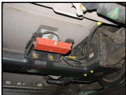
Figura 3.2.4.4 - Antena receptora ATP sota el comboi (Font: www.tramvia.org )
