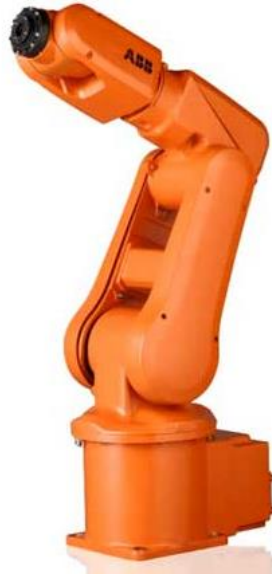
Figura 2.3: Braç robòtic IRB120, d'ABB
