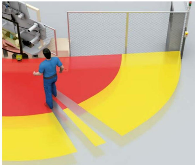
Figura 2.16: Escàners de zona de seguretat
