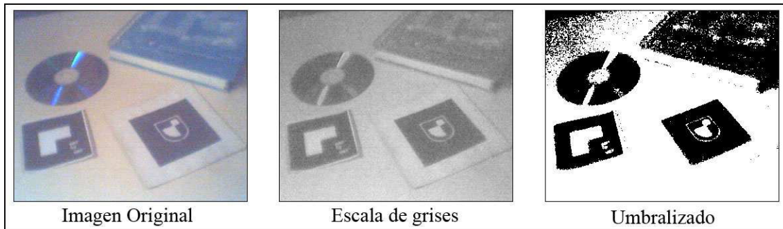
Figura 7 – La imagen original se convierte primero a escala de grises y luego se umbraliza.
