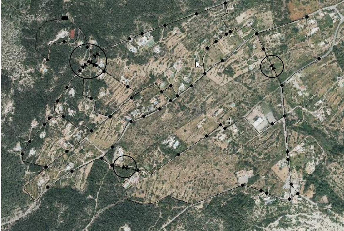
Figura 6.6. Localització de les vàlvules VRP a la nova xarxa hidràulica. [Elaboració pròpia]
