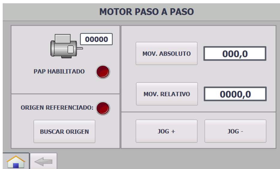
Fig. 2.10 HMI PAF200. Motor pas a pas [Font pròpia]
