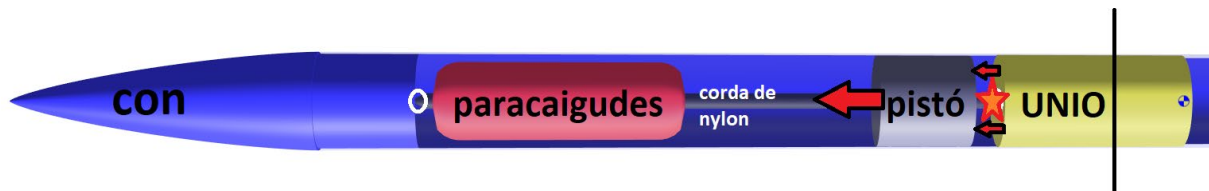
Il·lustració 7-1 Sistema d'alliberament per pistó [font: Elaboració pròpia]
