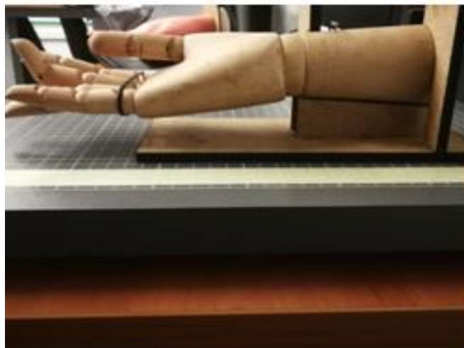
Fig. 5.3. Visualización del conjunto mano de madera-sujeción.
