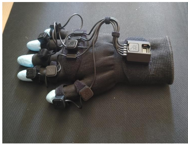
Fig. 5.37. Prototipo de mano para la prueba de estabilización.
