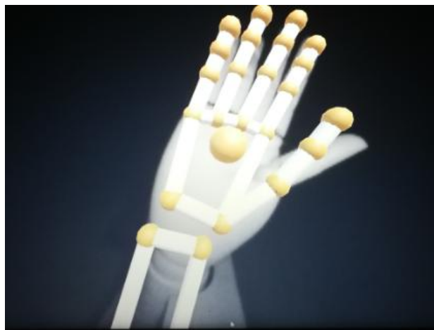
Fig. 4.14. Ejemplo de resultado del algoritmo de procesamiento de Leap Motion con una mano de madera.
