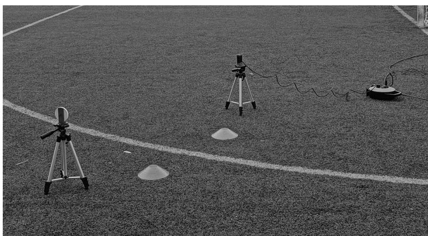
Ilustración 14. Montaje de las fotocélulas para los tests de sprint
