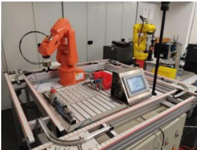
Il·lustració 11. Cel·lula de fabricació flexible amb 2 robots i estació de foradat font: (Peñalver, Primavera 2021)
