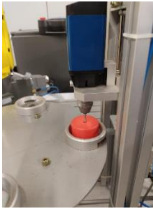
Il·lustració 9.Tercera subestació, Foradat de peça font: (Peñalver, Primavera 2021)
