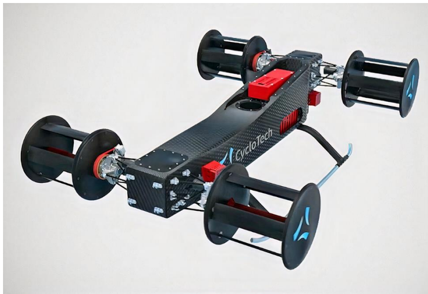
Figura 3.8 Prototipo VTOL con 4 ciclorotores de CycloTech [14]
