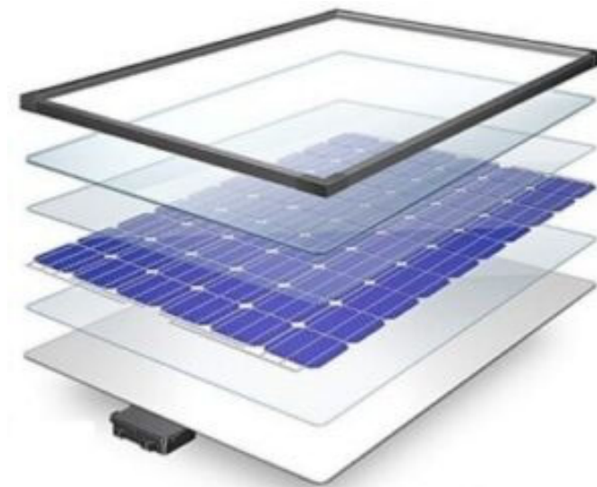
Fig. 3.9 Parts descompostes del mòdul fotovoltaic (Font: Google Images).
