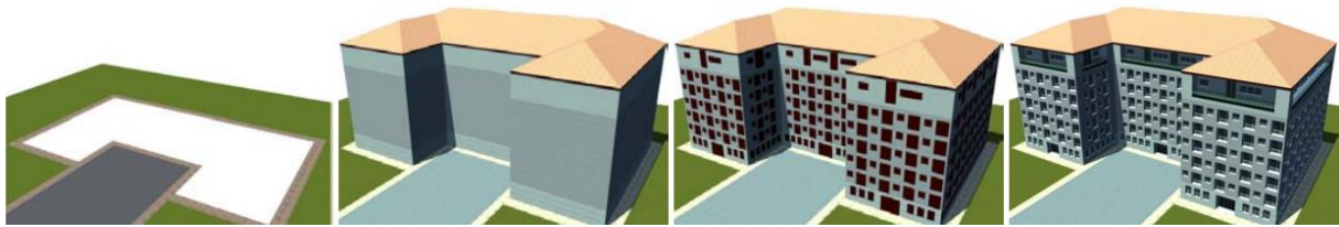
Figura 2-22. Exemple de derivació d'un edifici amb gramàtiques de paret. De dreta a esquerra: dades d'entrada (petjada de l'edifici), primer pas de la derivació, definir les àrees d'extrusió i el resultat final.
