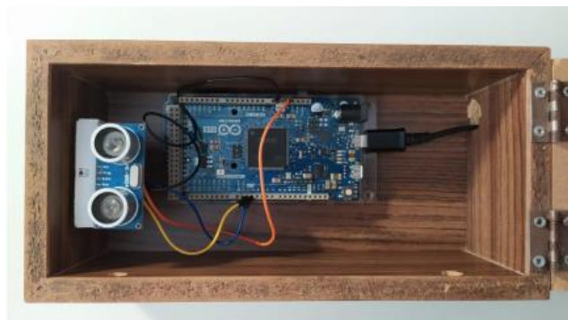
Il·lustració 5: Interior del prototip elaborat. Components electrònics convenientment connectats.
