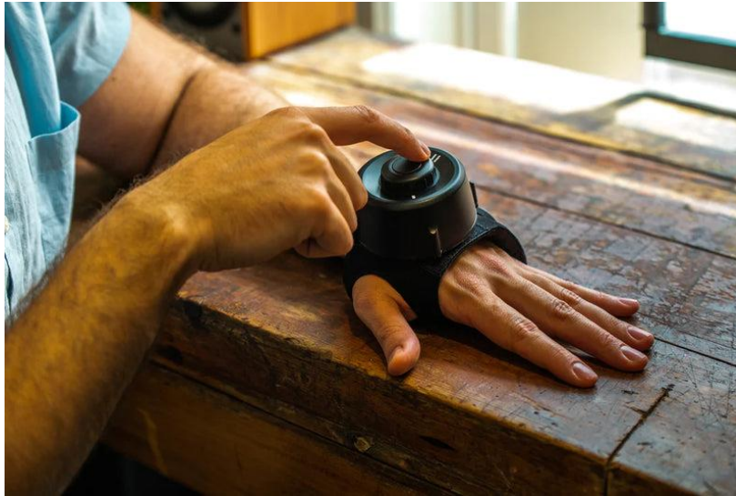
Il·lustració 26: . Guant Steadi-Two. A la part superior porta adherit un dispositiu que absorbeix les tremolors.
