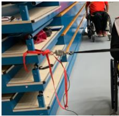
Ilustración 3. Colocación del sensor de fuerza
