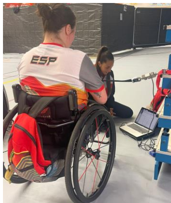
Ilustración 4. Colocación de la galga extensiométrica junto al jugador y del portátil como retroalimentación.
