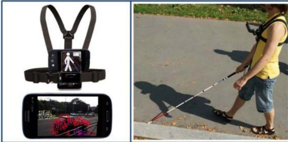
Figura 4. Sistema de aviso de movilidad con cámara móvil. Fuente: [11]
