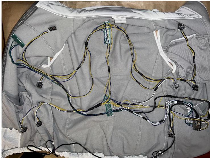
Figura 33. Cableado interno del chaleco. Fuente: Elaboración propia
