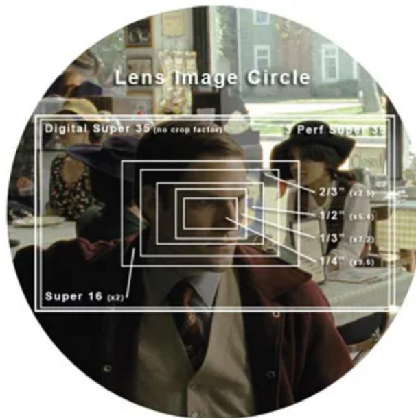
Figura 14. Comparación de tamaños de sensor. Fuente: Stump, 2014.
