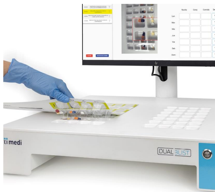
Figura 2.3. Fase de rellenado SPD semiautomático. Fuente: [9].
