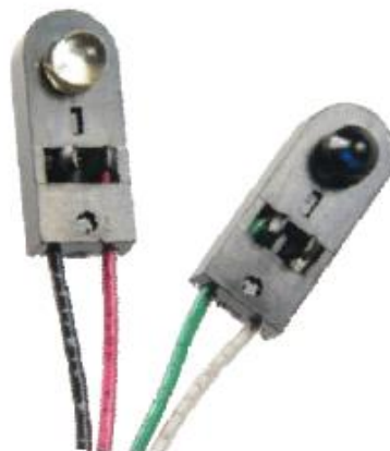
Figura 3.41. Sensores de infrarrojos Optek. Fuente: Propia.
