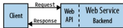
Figura 6.4.3.1. Interacció client-backend mitjançant una API. REST API Design Rulebook: Designing Consistent RESTful Web Service Interfaces , M. Massé, 2011.
